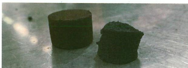
A sinistra, una bricchetta di ossido di ferro e biocarbone, a destra la spugna di ferro.
